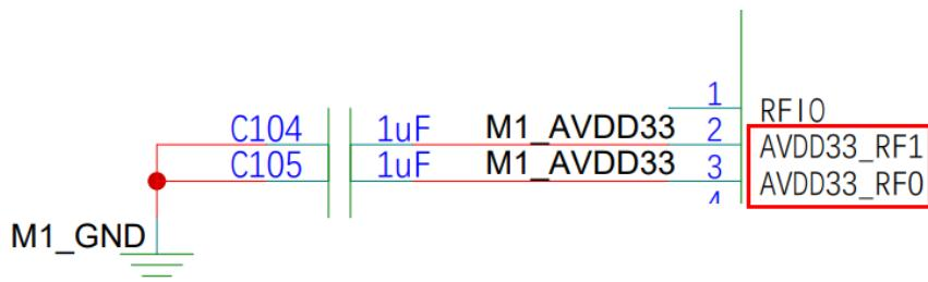
图3-15 RF 供电电路设计参考 2
