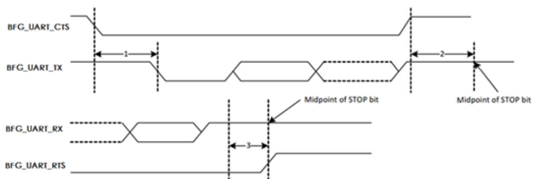
注：图中虚线的信号上升沿按照  $0.7 \times VDD$ ，下降沿按照  $0.3 \times VDD$  选取。
