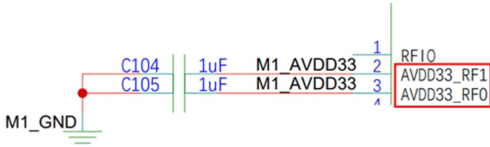
图3-8 WS63V100 AVDD33 输入电路 2
