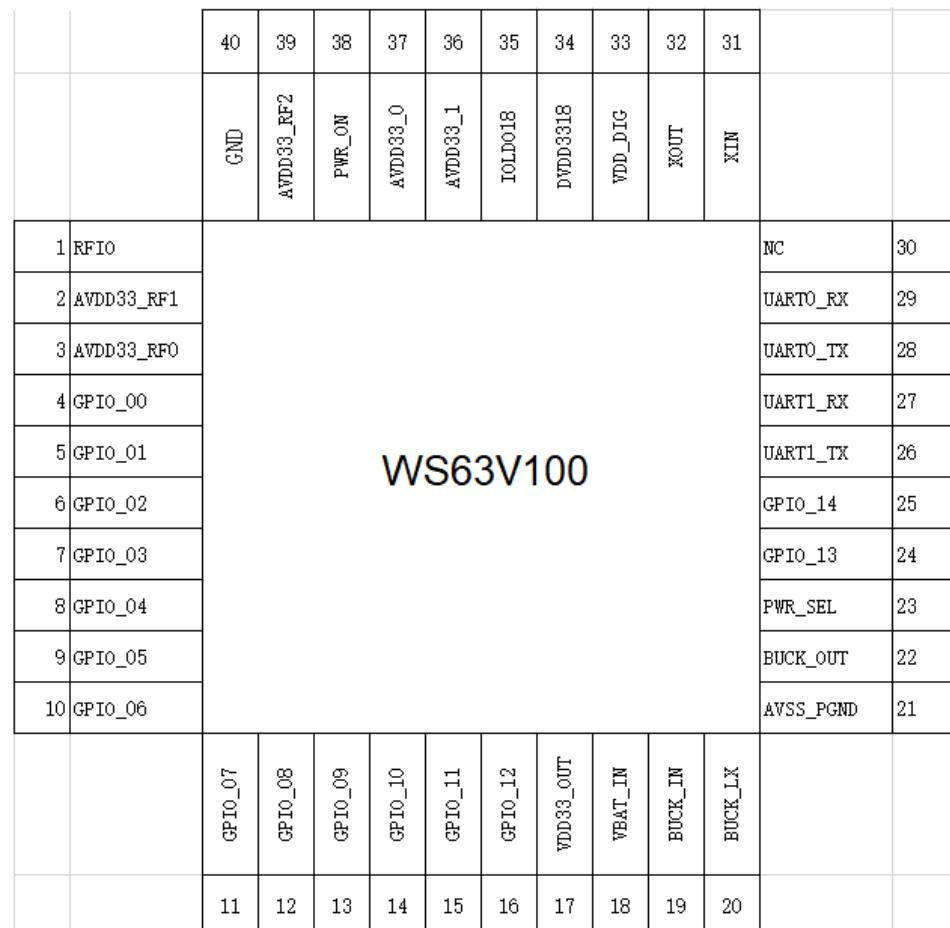
图1-5 WS63EV100 TOP View 管脚分布
